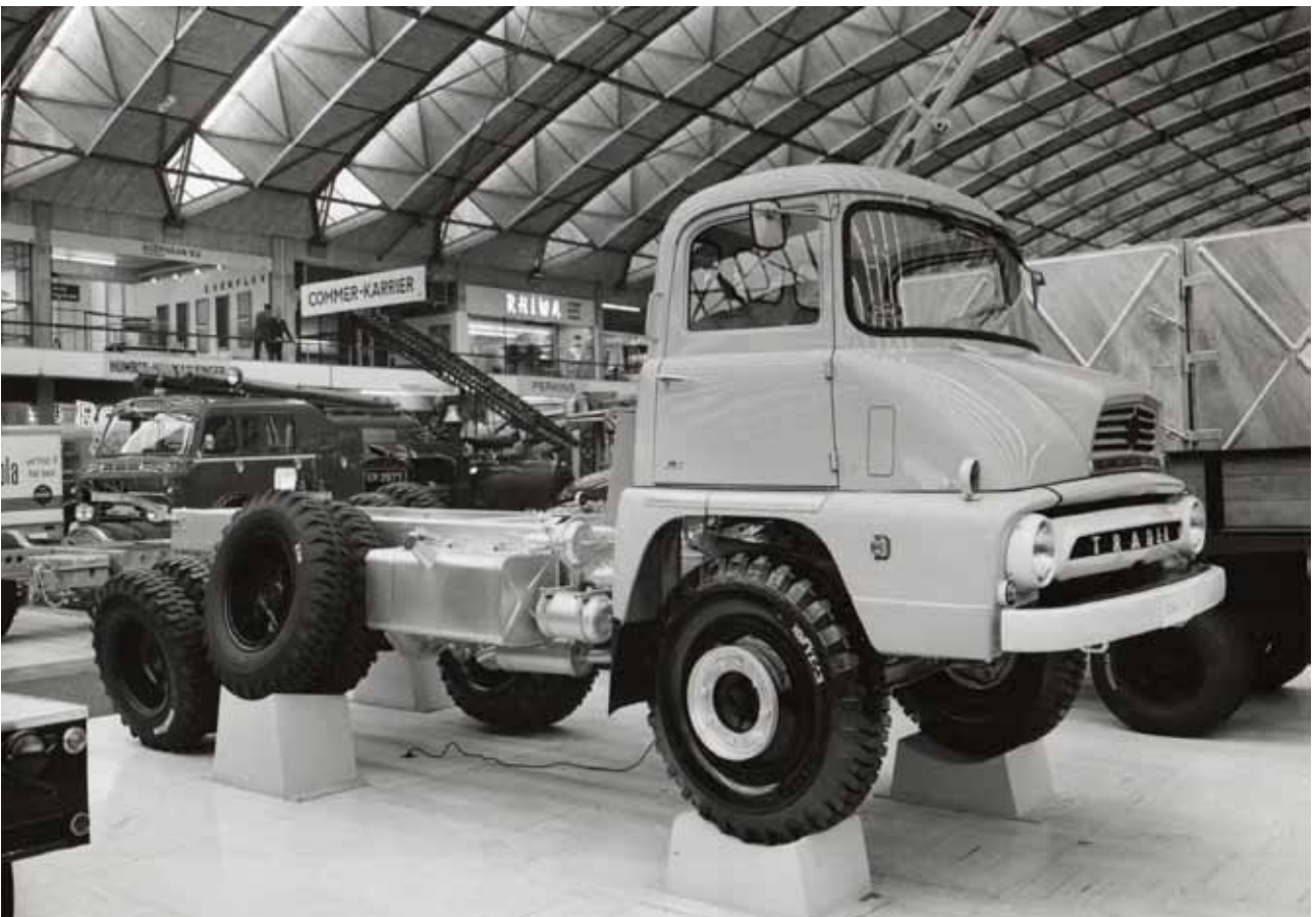
Voorzijde Thames Trader (FC Forward Control) in 6x4 uitvoering t.b.v. kipperopbouw. 1964
