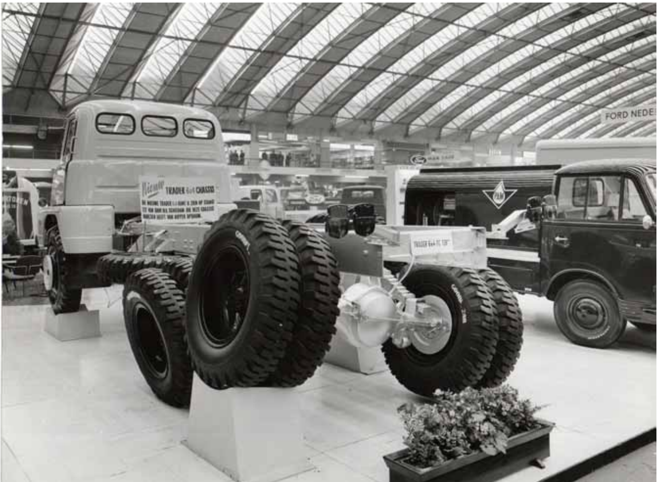
Achterzijde Thames Trader FC (Forward Control) in 6x4 uitvoering t.b.v. kipperopbouw 1964
