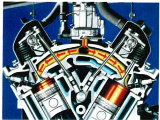
3 — Korte brandstofwegen. De carburateur staat tussen de cilinders en de mengsel-aanzuigkanalen zijn kort. Zuinig, hoger rendement.
