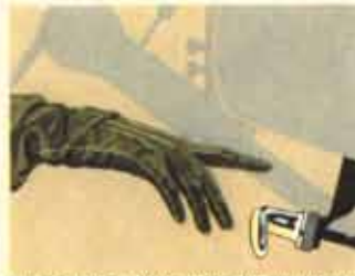
Le frein à main, forme canne, qui se trouve à droite de la colonne de direction, est également à portée immédiate de la main du conducteur ainsi que de la personne assise à ses côtés.
