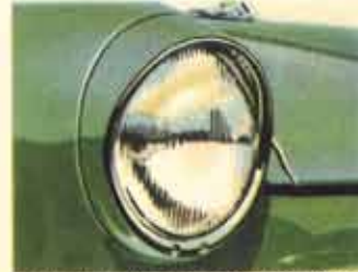
Le dispositif anti-éblouissement des phares montés en position élevée séduit pas seulement à cause de sa forme esthétique, mais facilite également la conduite par temps de brume.
