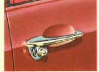
La main s'adapte facilement aux poignées des portières. Celle-ci s'ouvrent par une légère pression du pouce sur la serrure située en-dessous de la poignée.
