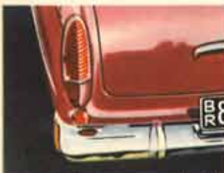
A l'arrière de la voiture se trouvent réunis les feux stop, les feux AR ainsi que les indicateurs de direction dont l'éclat est renforcé par un miroir parabolique.
