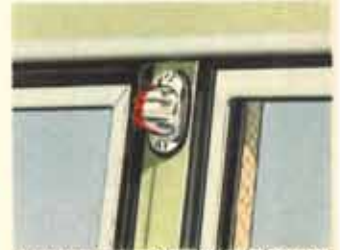
Des clignoteurs supplémentaires latéraux augmentent la sécurité routière. Ils peuvent également être utilisés comme feux de position à consommation économique.
