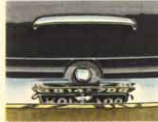
Le bouchon du réservoir à essence, situé derrière la plaque d'immatriculation relevable à l'arrière, permet de faire le plein d'essence des deux côtés de la colonne de ravitaillement.
